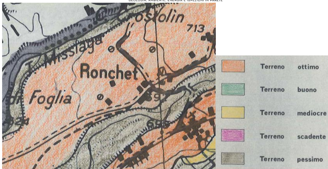
Fig.5 - Estratto della carta delle penalità ai fini edificatori allegata allo Studio Geologico del P.R.C.G. (De Col L., decima A., 1984).
